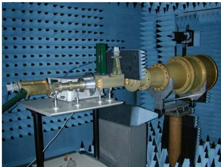
Fig. 8 Feed system nella banda 4.3÷5.8GHz
