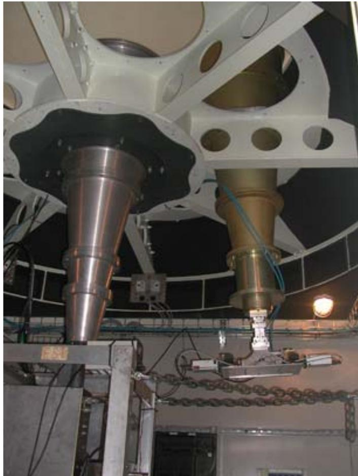
Fig. 14 I due ricevitori attualmente montati in vertex room
