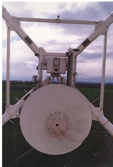
Fig. 6 Coesistenza della scatola ricevitori nelle bande S/X/K/L e il subriflettore
