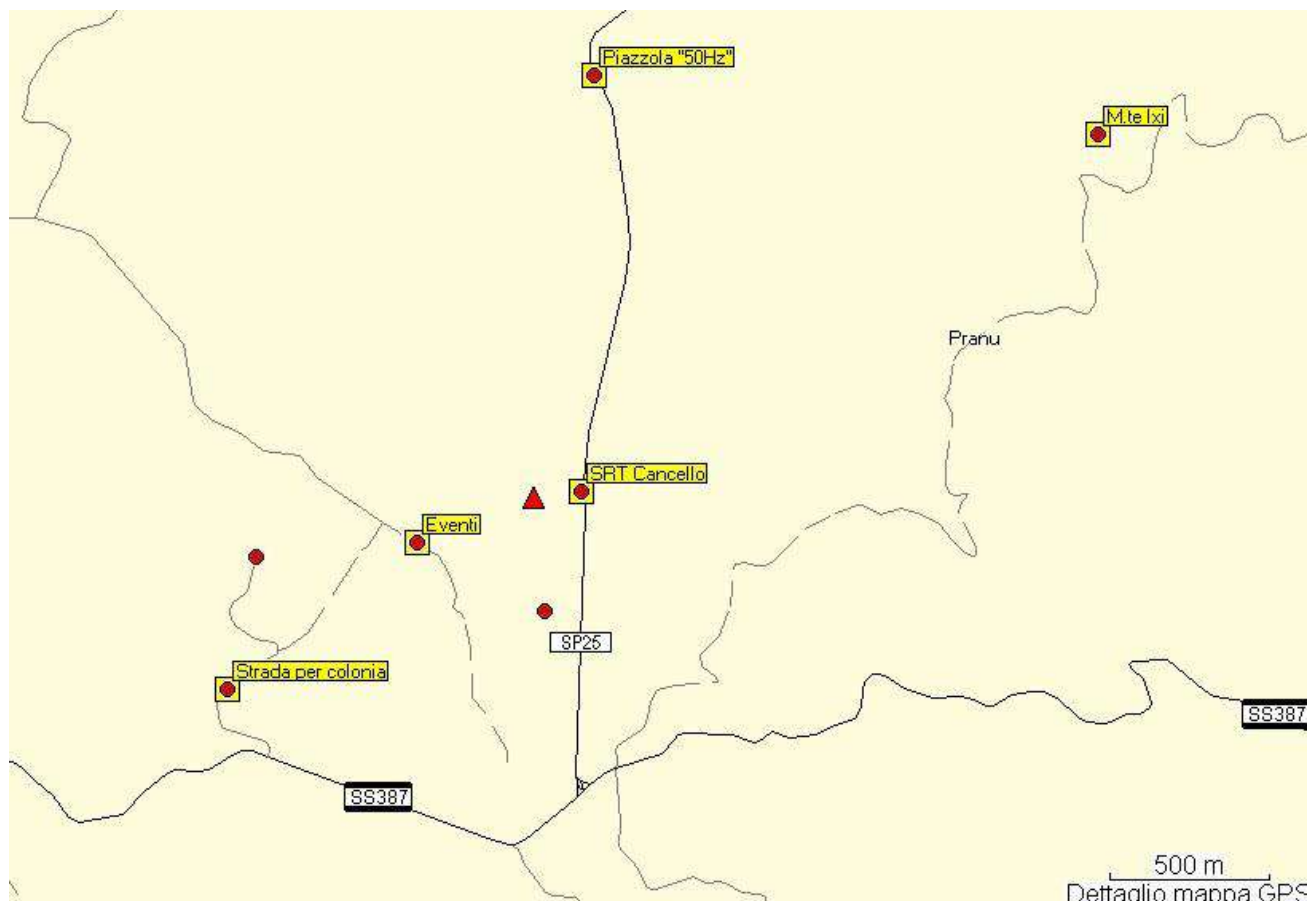
Figura 3 – Mappa dell’area nei pressi di SRT, in cui si evidenziano i punti di particolare importanza da cui sono state effettuate delle misure di RFI
