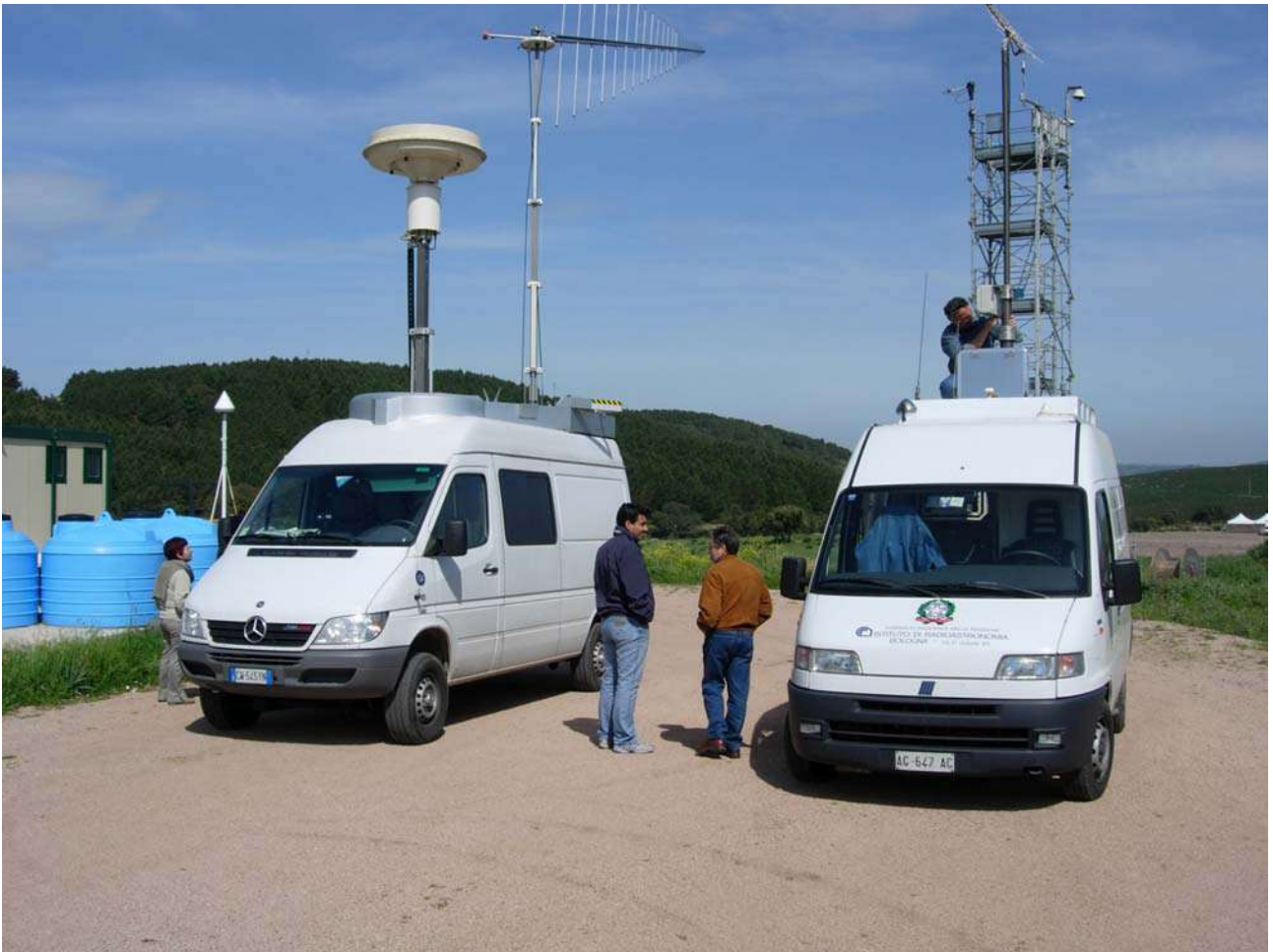
Figura 1 – Un momento della campagna congiunta con l’Ispettorato, presente con il proprio furgone su base Mercedes, dotato di antenna Log-Periodica ed un radio goniometro
