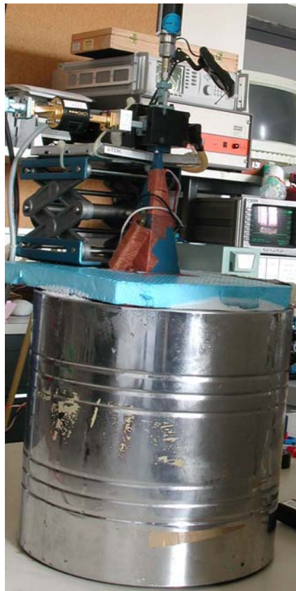
Fig. 26: Carico freddo WR 42 per misure nella banda 18-26 GHz
