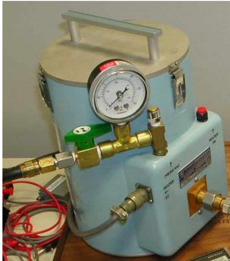
Fig. 6: Carico freddo della Maury Microwave® MT7118A opt.10 (S/N 143)
