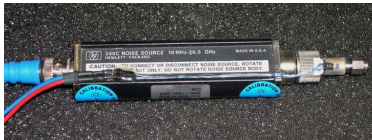
Fig. 15: La sorgente di rumore HP 346C con attenuatore da 6 dB e sensore al platino
