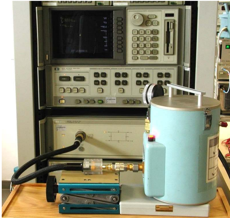
Fig. 9: Set up di misura del coefficiente di riflessione del carico freddo MT7118A
