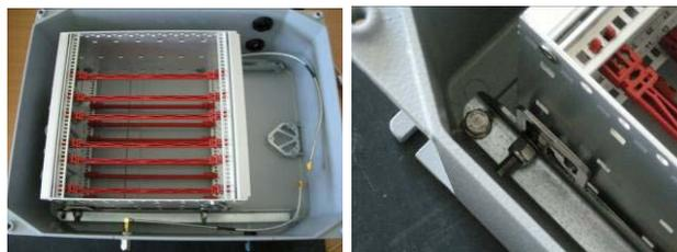
19. Realizzare due cavetti necessari per la messa a massa dei cavi di alimentazione, crimpando un occhio per M6 ad un cavetto elettrico.
