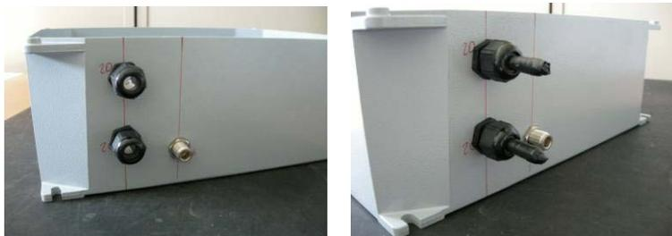
6. Inserire un passacavo Skintopp ST-M 12x1,5 stretti con controdadi Skintopp GMPL-GL-M 12x1,5 all'interno del foro di diametro 12 mm presente sulla scatola ILME. Inserire un "tappo" per impedire all'acqua di entrare. Per assicurare una tenuta migliore mettere della pasta siliconica tipo Motorsil tra il passacavo e la scatola.
