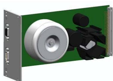
3. Unire due blocchetti di montaggio Schroff cod. 60807-181 alla scheda Front-End mediante 2 viti a testa cilindrica impronta a croce M2,5 L 8 mm.
