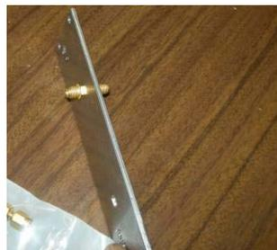
9. Sulla transizione SMA passa paratia F-F Radiall cod. R125.720.000 fissata nel punto precedente fissare una transizione SMA M-M Radiall cod. R125.703.000.
