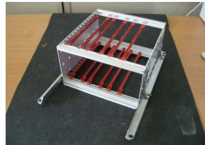
17. Realizzare un Back-Plane con Flat-cable sfruttando 6 connettori din da crimpare cod 09 03 264 6828 distanziati l'uno dall'altro di: 55mm, 40mm, 55mm, 45mm e 50mm. Fissarli sui profilati posteriori utilizzando 12 viti a testa cilindrica impronta a croce M2,5 L 5 mm.
