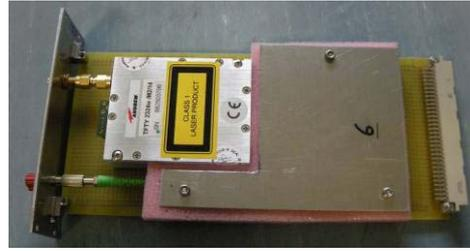
21. Fissare il trasmettitore ottico mediante 4 viti a testa cilindrica impronta a croce M3 L 6 mm, interponendo tra la scheda e le viti delle rondelle piane M3. Il trasmettitore ottico è così completamente assemblato.
