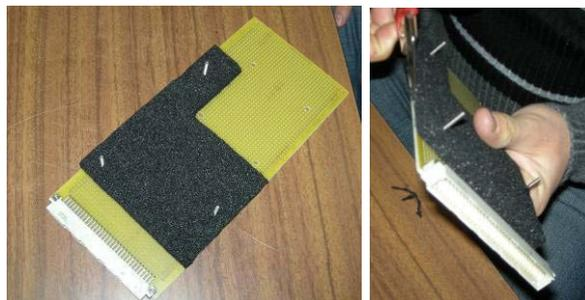
19. Ri-fissare il pannello frontale assemblato precedentemente, distribuire la fibra sulla guarnizione e fissarne il codino sulla bussola.
