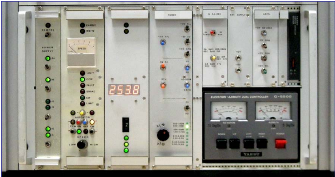
Figura 8 – il Rack 19"/6U con i vari moduli per il controllo remoto dei Sistemi Torre ed Az-El
