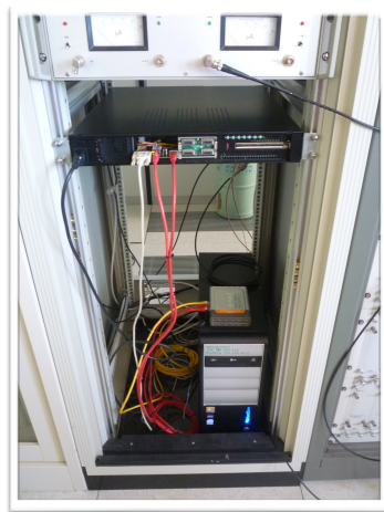
Fig. 2 Installazione di schede ROACH presso le stazioni di Noto (sinistra) e Medicina (destra)
