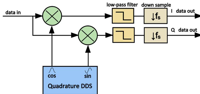
Fig. 16: DDC schematic
