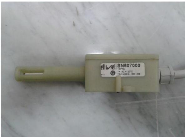
Per il corretto funzionamento, il tipo di sonda utilizzata deve essere specificata al parametro n.2 del controller in quando esso può riconoscere diversi tipi di sensori (resistori, dispositivi a semiconduttore, termocoppie,..., etc.).
