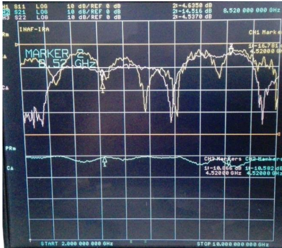
Fig.51 Perdita del splitter 8 vie (traccia azzurra) -10dB@4,5GHz e -14dB@8,5GHz
