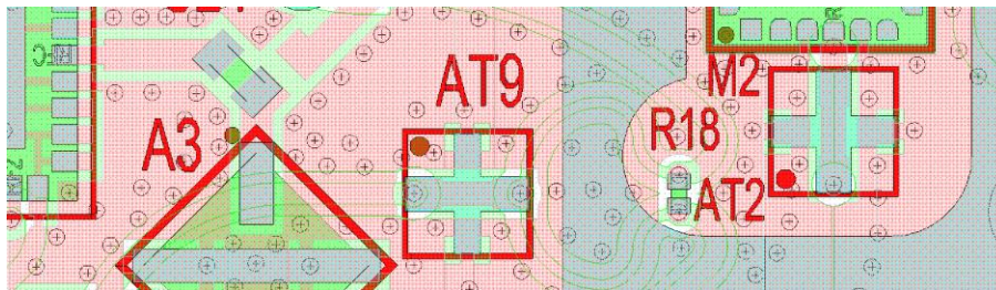
Fig.47 Predisposizione AT9 e AT2 e rispettivi canali.
