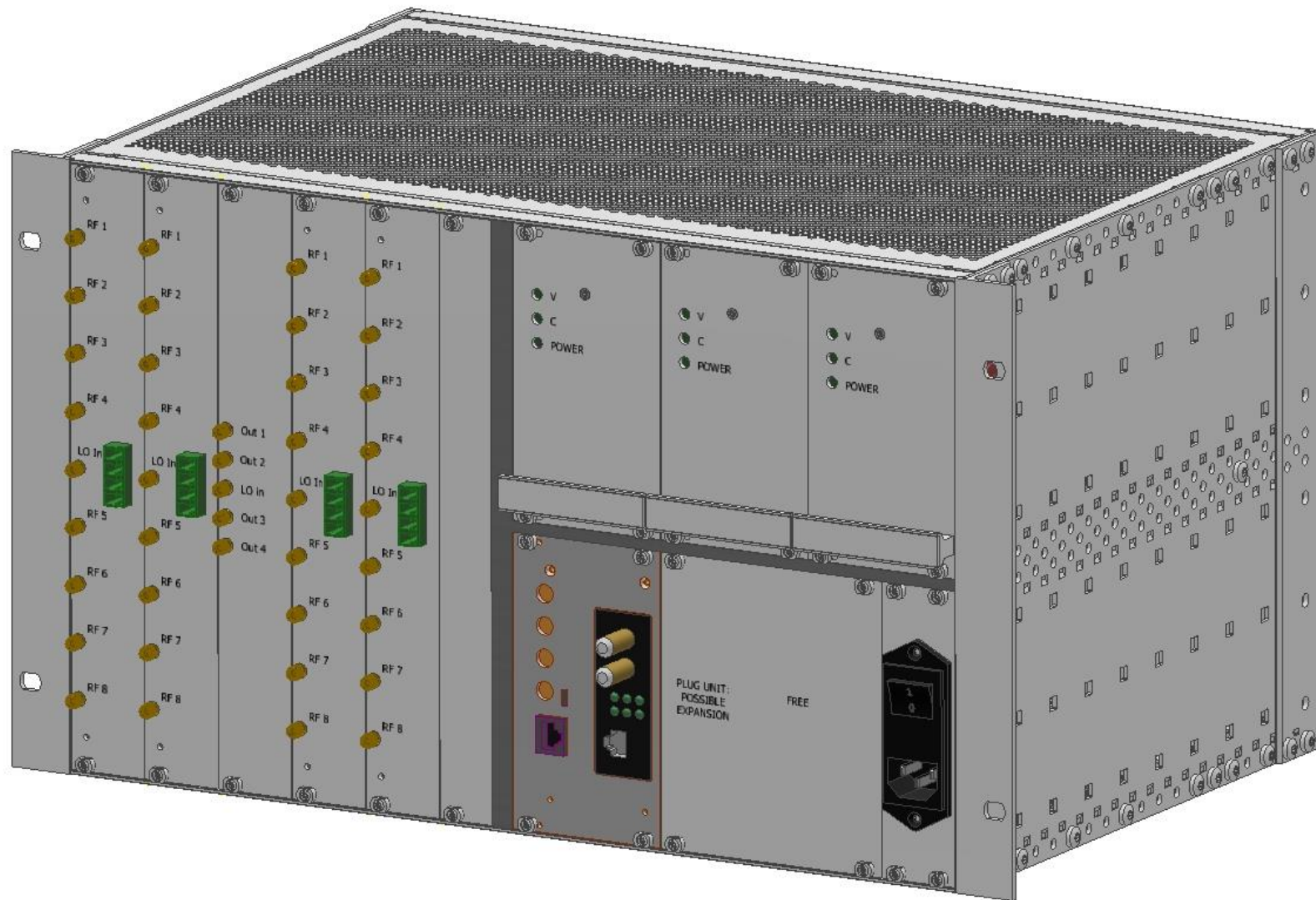
Fig. 5 Design del cestello rack con 4 PCB WS ed uno splitter a 4 vie per l'oscillatore locale (fra due PCB WS).
