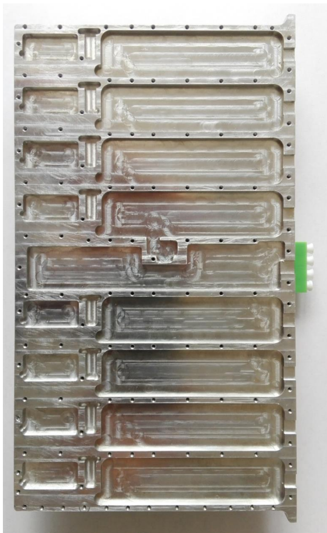
Fig.36 Carter di chiusura con nicchie fresate
